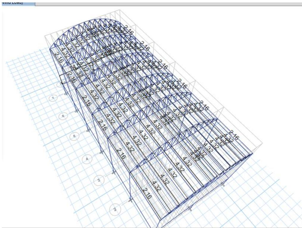
**Fig: WIND Load Assign Details**
