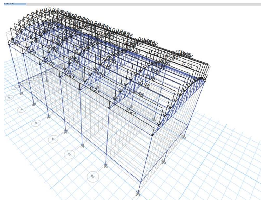
**Fig: Roof Live Load Assign Details**
